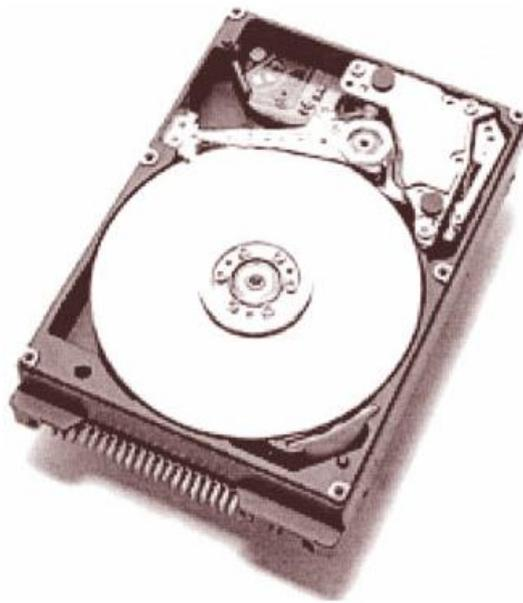
图 1-2 IBM25Gbit/in<sup>2</sup> 硬盘驱动器<sup>[26]</sup>
